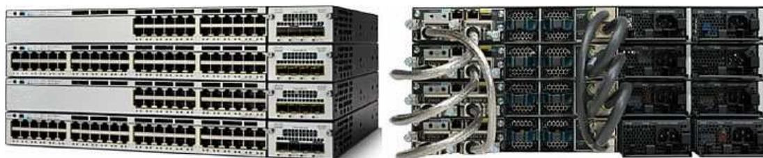
Este tipo de switches están diseñados para formar el núcleo o troncal de una red de tamaño medio. Proporcionan altas prestaciones y funcionalidades avanzadas. Una de las principales diferencias con los switches perimetrales es que ofrecen características de nivel 3 como enrutamiento IP. A continuación, se exponen sus características más representativas:
